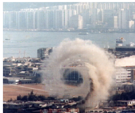
Abb. 1: Wirbelschleppe, die von einer B747 im Landeanflug auf den alten Hongkonger Flughafen erzeugt und durch eine Abgasfahne sichtbar gemacht wird.
