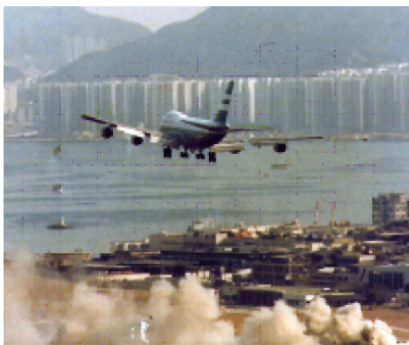
Abb. 1: Wirbelschleppe, die von einer B747 im Landeanflug auf den alten Hongkonger Flughafen erzeugt und durch eine Abgasfahne sichtbar gemacht wird.
