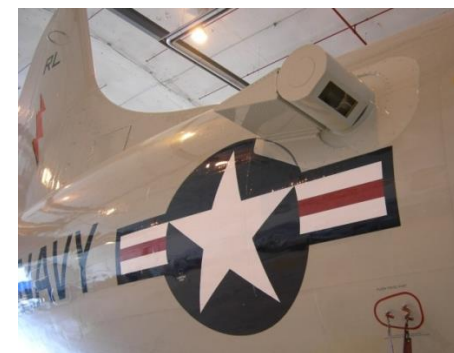
Doppler Wind Lidar
